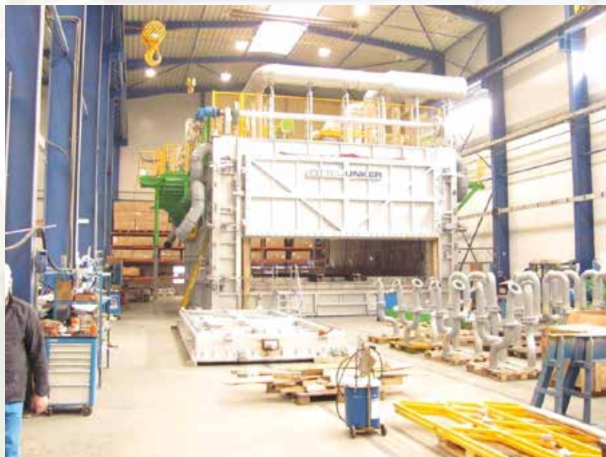
Montirana peć u OTTO JUNKER fabrici u Češkoj, spremna za isporuku u Sevojno
